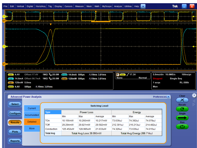
Измерение коммутационных потерь. Функции автоматического измерения параметров питания позволяют быстро и точно анализировать общие характеристики источников питания.
